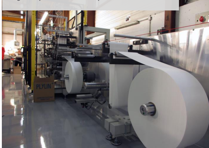
Ligne de production de masques- entrée meltblown
